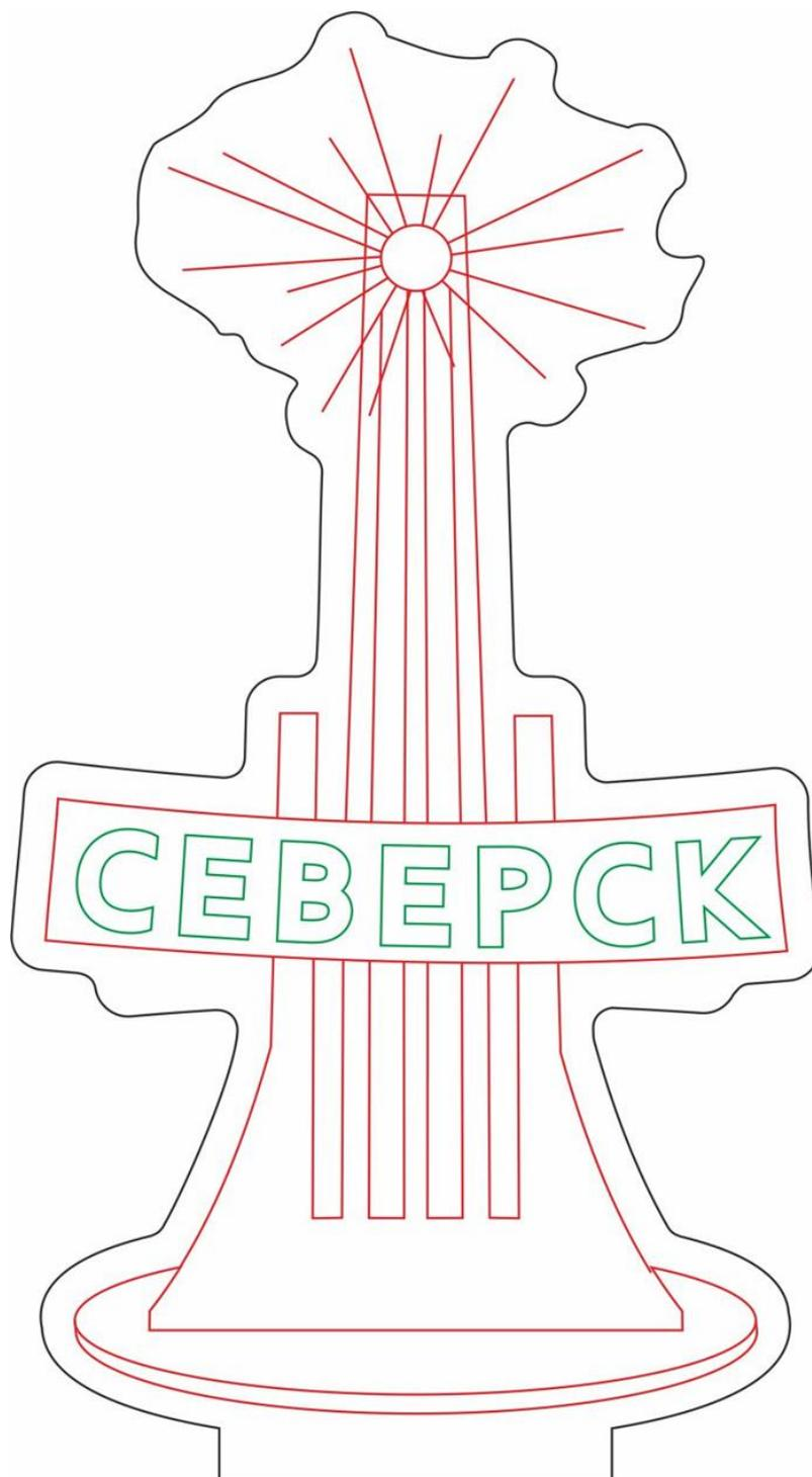
**Внимание!** При подготовке файла учитывайте, что толщина реза лазерного луча составляет 0,2 мм. Во избежание прослаблений в соединениях типа шип-паз и при наличии вкладных деталей необходимо учитывать компенсацию размеров на указанную величину.
